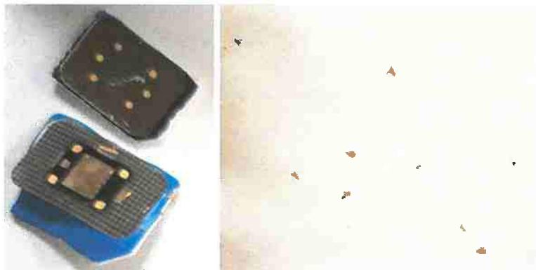
Figura 17 - Cartão SIM após ensaio de peeling do ouro por 30 minutos a 85°C e ouro recuperado
