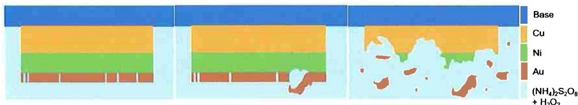
Figura 19 - Esquema do mecanismo de extração do ouro pelo método de peeling
