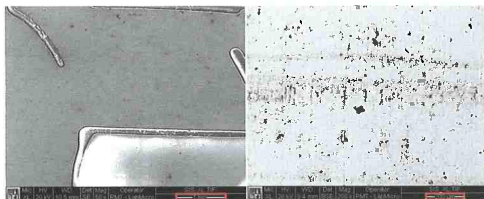
Figura 12 - Imagens obtidas pelo MEV da amostra C. Esquerda: SE; escala: 1mm. Direita: BSE; escala: 50 \mu m
