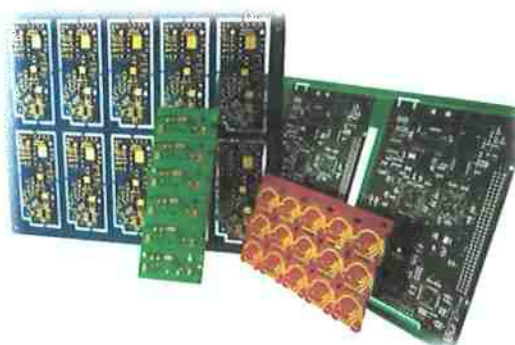
Figura 1 - Placas de Circuito Impresso com revestimentos ENIG (esquerda fundo), OSP (esquerda frente), Imersão de Estanho (direita fundo) e Ouro Eletrolítico (direita frente)
