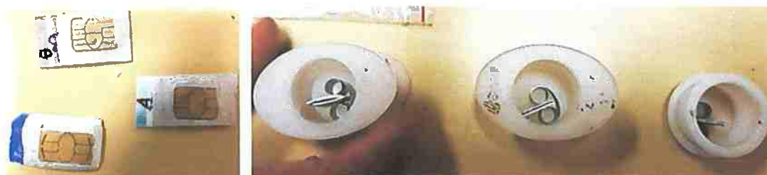
Figura 6 -a) Preparação dos chips com tinta prateada para observação no MEV. b) Amostras dentro do molde para embutimento em resina polimérica
