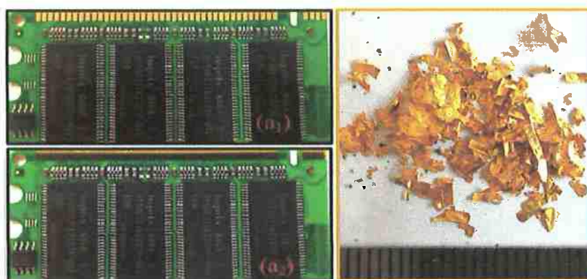
Figura 4 - Lado esquerdo: (a1) Cartões de memória antes do ensaio de "peeling" do ouro (a2) cartões de memória após o ensaio; Lado direito: Ouro recuperado
